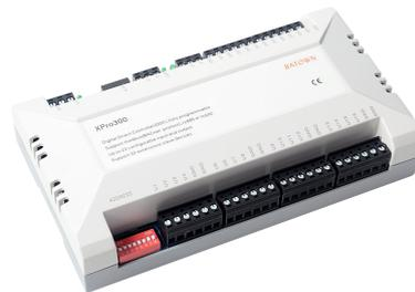
XPro300 是一款输入输出灵活、高性价比多功能的 DDC 控制器, 具有 Digital Input/Output 及 Analog Input/Output 等常用的控制点位。用户可根据需求, 选择 1 至 4 个功能不同的内部扩展模块组合, 最多可提供 22 个 I/O 点, 并可外部扩展 XPro100 或 XPro200 系列 IO 模块或控制器, 最多支持 64 个子设备, 支持最多 2048 个变量编程。
